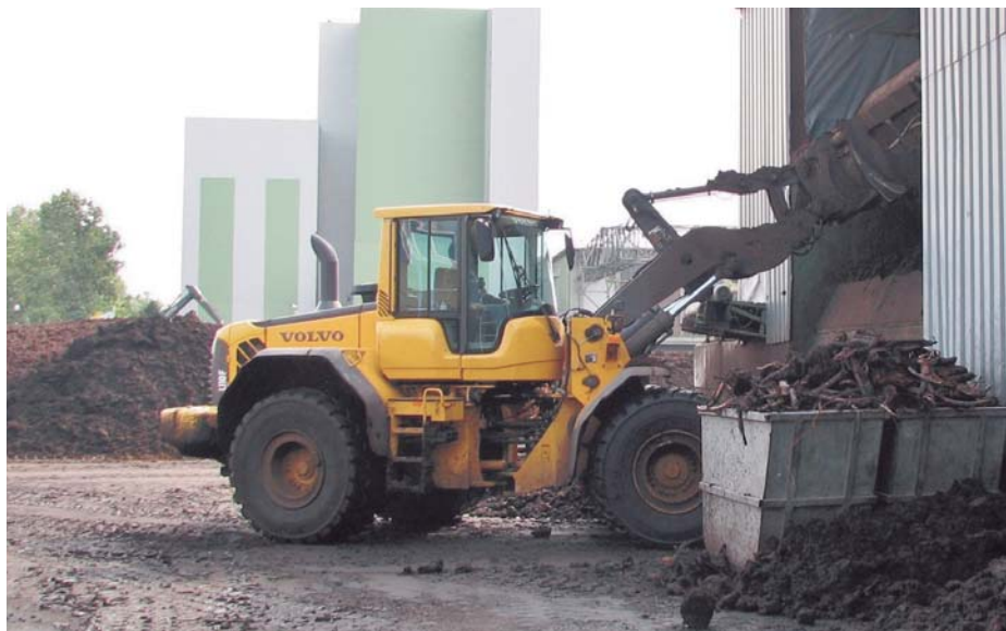
Afb. 2 Een shovel belaaft de veenbunker
